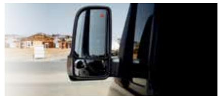
**L'AVERTISSEUR D'ANGLE MORT<sup>4</sup>** utilise des capteurs radars pour surveiller les zones derrière et sur les côtés de votre véhicule; si un véhicule est détecté, un avertissement visuel apparaît dans le rétroviseur extérieur. Le système d'alerte de circulation transversale arrière<sup>5</sup> freine automatiquement afin d'éviter une collision en cas de passage croisant la trajectoire de votre véhicule (p. ex. véhicules ou piétons) lorsque vous êtes en marche arrière.
