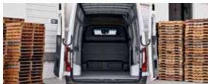
Les portes arrière sont dotées de charnières équipées de mécanismes de verrouillage automatique, et peuvent ouvrir à 270 degrés en option.
