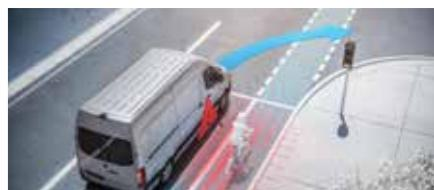
**LE SYSTÈME DE DÉTECTION DU CÔTÉ PASSAGER<sup>6</sup>** fournit des avertissements visuels et sonores lors des virages lorsqu'un utilisateur de la route (p. ex. un cycliste) se trouve dans une zone pré définie sur le côté passager.
