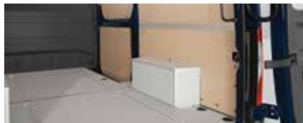
Des rails d'arrimage sur le côté et le plancher facilitent le transport sécuritaire du chargement.<sup>16</sup>
