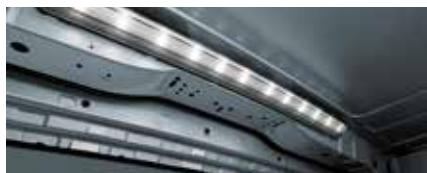
Les bandes d'éclairage à DEL rehaussent la visibilité dans l'espace de chargement.
