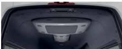
La climatisation montée sur le toit offre deux niveaux de puissance, dont un système à haut rendement.
