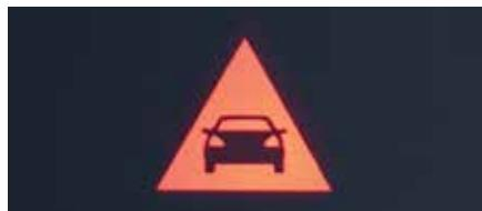
**L'ASSISTANCE ACTIVE DE FREINAGE<sup>2</sup>** détecte la probabilité d'une collision avec un véhicule devant vous, et vous envoie un avertissement visuel et sonore; le freinage autonome peut également être activé.
