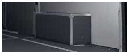
Offerte sur les modèles à pneus simples, la forme carrée avec surface plane de cette protection de passage de roue offre des possibilités de rangement tout en protégeant le passage de roue.
