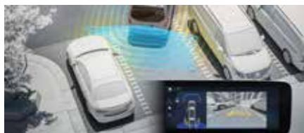
**LE PACK STATIONNEMENT<sup>7</sup>** utilise douze capteurs de distance et la caméra de recul afin de vous aider lors du stationnement dans de petits espaces ou dans les sorties. Il vous avertit de la présence d'objets autour du véhicule, limite la vitesse au démarrage si des obstacles sont détectés et affiche des lignes de guidage dynamiques lorsque vous utilisez la marche arrière.
